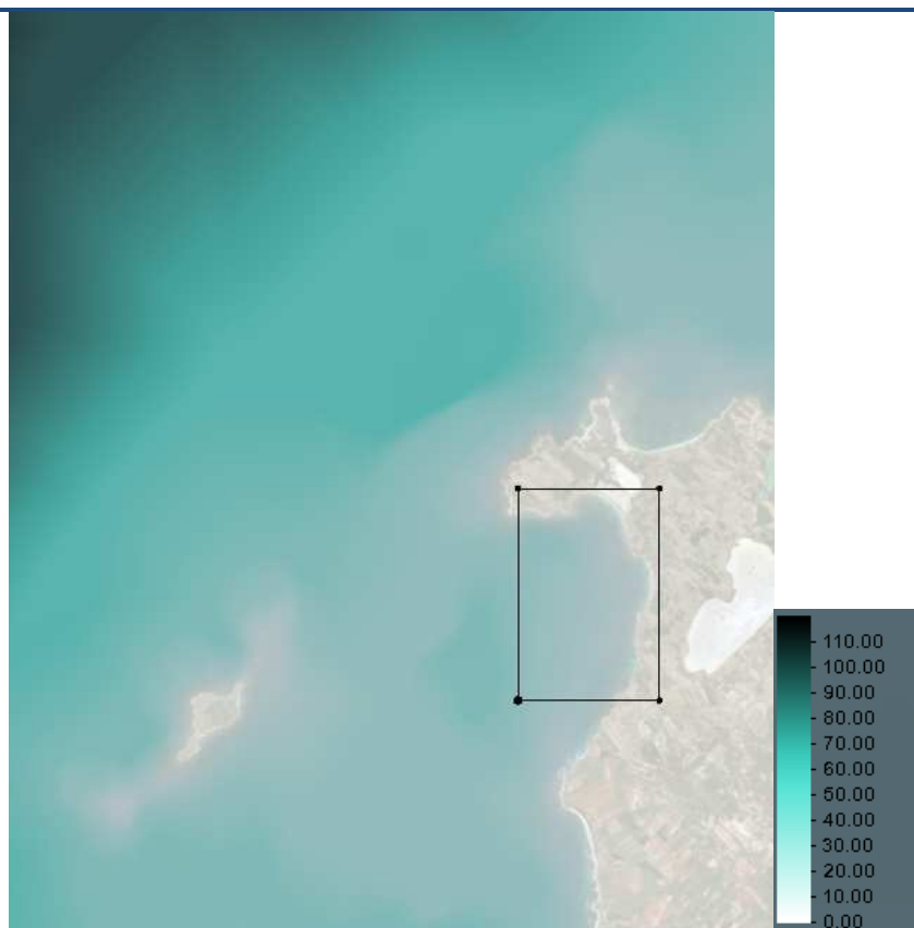
Figura 21. Batimetria di riferimento e griglia di calcolo - (direzioni 225-270-315°)
