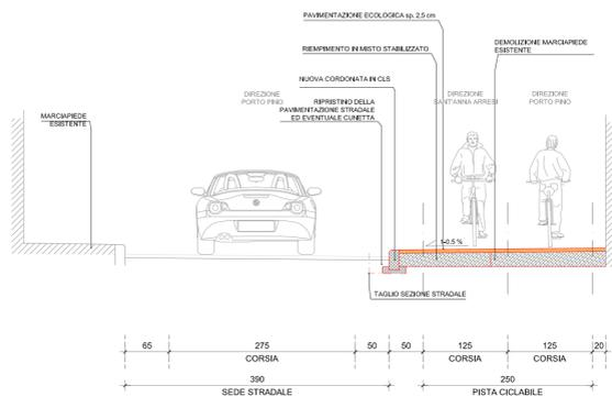
ATTRAVERSAMENTO - Sezione Tipo **A1** Longitudinale - Scala 1:50
