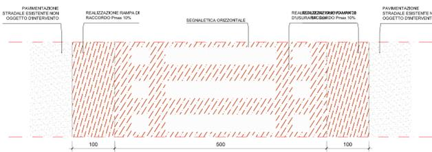
ATTRAVERSAMENTO - Sezione Tipo **A2** Longitudinale - Scala 1:50
