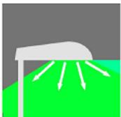
Una parte consistente degli apparecchi di illuminazione esistenti di installazione più recente, sono invece risultati adeguati, presentando buone condizioni di conservazione, schermo di chiusura piano (ottica cut-off) ed elevati rendimenti ottici (ottiche di recente costruzione) ed installati correttamente (inclinazione nulla rispetto al piano stradale).
