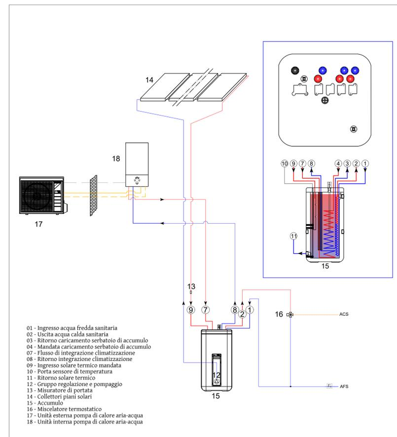
SCHEMA IMPIANTO SOLARE TERMICO CON POMPA DI CALORE
